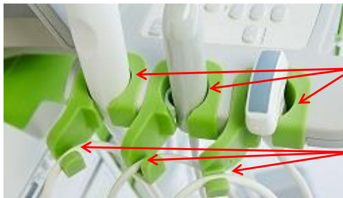
Rys. 16: Uchwyt na przetwornik/żel i prowadnicę kabla
