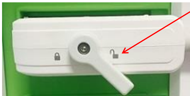
Rys. 11: Odblokowane pokrętło blokujące złącza przetwornika
