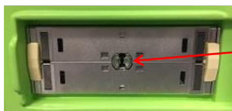
Rys. 9: Wycięcie blokujące w gnieździe złącza przetwornika
